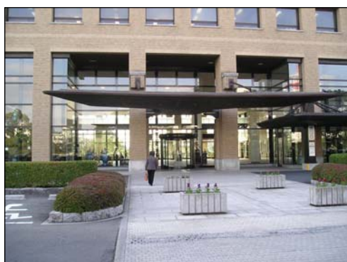
誘導用ブロックが床材と同色のため見分けづらく、花壇が車いすや視覚障がい者などの通行の障がいとなる
